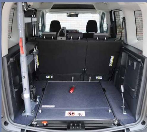
**Système Easy-Flex** breveté, la rampe se rabat à l'horizontal, il devient le fond de votre coffre et facilite le chargement des bagages.
