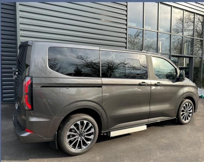
La plateforme K70 se range dans un caisson en inox ultra plat situé sous le plancher du véhicule, garantissant une garde au sol optimale.
