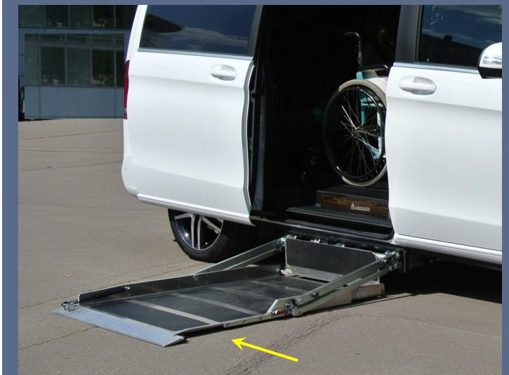
OPTION : La découpe latérale du plateau permet de faciliter une sortie sur le côté, lorsque la plateforme se trouve près d'un obstacle.
