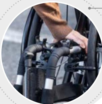
Le système de verrouillage automatique (optionnel) **FOLD-N-LOCK** maintient le fauteuil plié en toute sécurité. D'un simple "clic", votre fauteuil roulant reste plié aussi compact que possible et verrouillé dans cette position. Le **dépliage involontaire** pendant le levage ou le chargement est ainsi **évité**.
