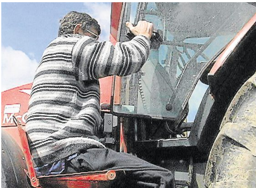
Pour continuer à travailler, une plateforme élévatrice a été installée sur le tracteur.
